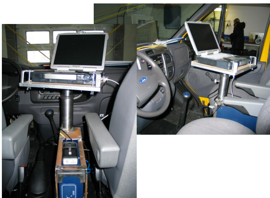
Rysunek 5 Zainstalowana w samochodzie jednostka centralna wraz z komputerem pomiarowym
