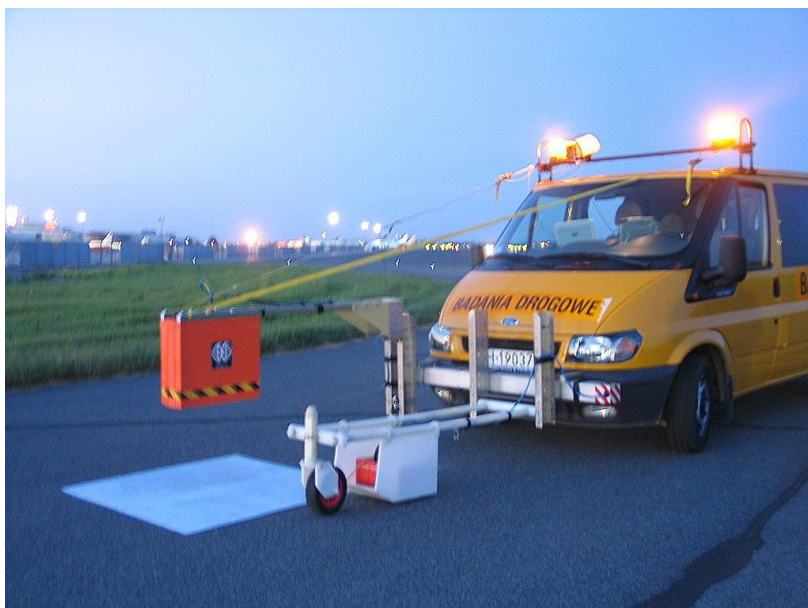
Rysunek 4 Samochód pomiarowy z zainstalowanymi antenami 1,0 i 0,4 GHz
