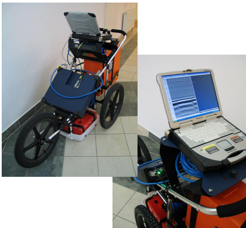
Rysunek 6 Wózek pomiarowy z antenami 400MHz i 2,2GHz
